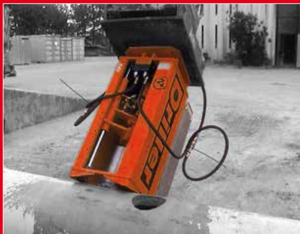
Wykonywanie przyłączy rur
