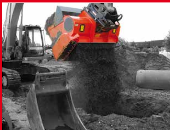
... bezpośrednio w zasypywanym wykopie
